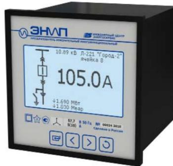
При использовании графических ЖКИ обеспечивается визуальное представление телеизмерений в виде виртуального аналогового щитового прибора (одно и трехфазный амперметр, вольтметр, ваттметр и т. д.), отображение мнемосхемы присоединения с отображением ТИ и индикацией состояния коммутационной аппаратуры по данным ТС, отображение векторных диаграмм, трендов телеизмерений и т. д.
