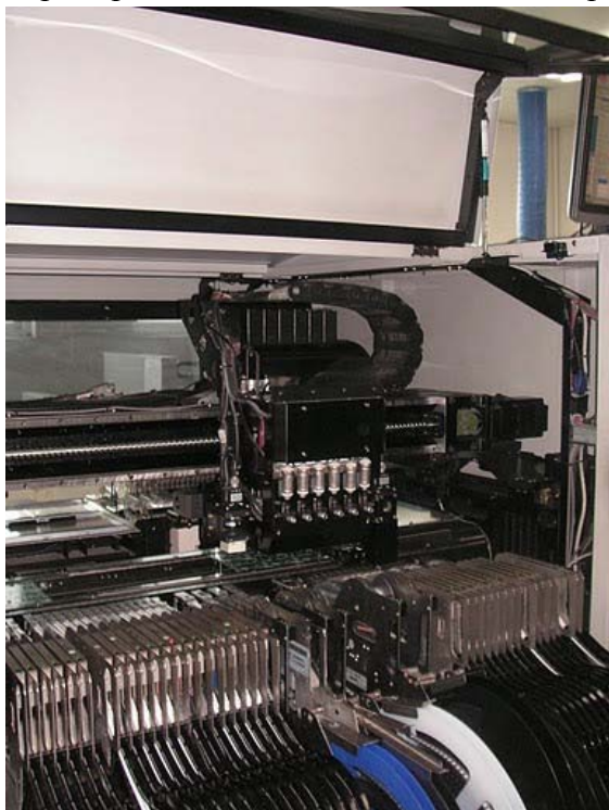
Автоматизированный монтаж SMD компонентов плат
