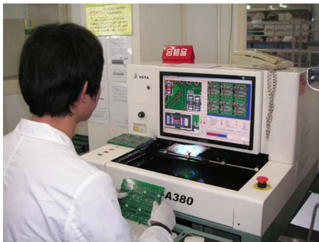
Автоматизированное тестирование печатных плат
