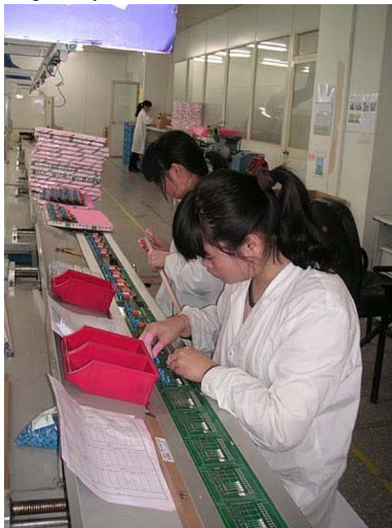
Конвейер ручного монтажа компонентов, для которых не предусмотрена автоматическая установка
