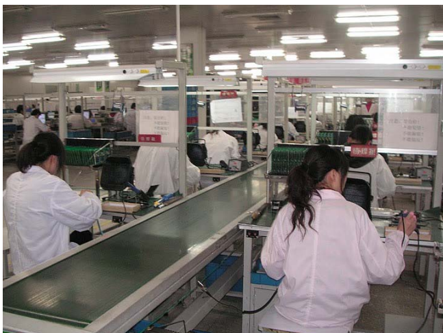
Ручная пайка отдельных элементов плат
