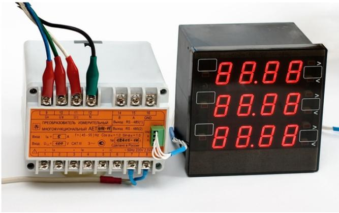
Устройство индикации AED (далее – устройство) предназначено для подключения к измерительному многофункциональному преобразователю АЕТ, имеющему два независимых интерфейса RS-485, для отображения результатов измерений трех любых измеряемых преобразователем параметров.
